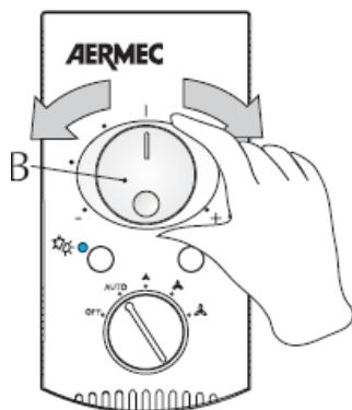
С помощью этого регулятора задается нужная температура воздуха. Температура, соответствующая центральному положению переключателя, зависит от режима работы вентиляторного доводчика: при нагреве она составляет 20°C, при охлаждении она равна 25°C. Минимальное и максимальное значения температуры, соответствующие крайним положениям переключателя, на 8°C больше и меньше температуры, отвечающей центральному положению.
