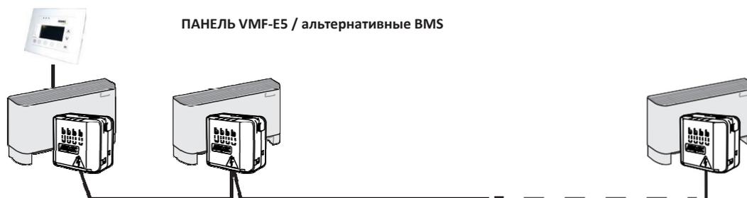
Как показано на рисунке, установив плату расширения VMF-IO вы можете управлять фанкойлами с помощью панели VMF-E5 или альтернативных систем BMS без необходимости использования панели VMF-E4/E2. Для корректной работы фанкойлов к устройству должен быть подключён датчик температуры воздуха.
