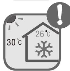
При работе в режиме охлаждения нельзя держать температуру в помещении слишком низкой. Нужно соблюдать разницу температур в 5°C между воздухом внутри и снаружи помещения.
