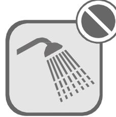
Нельзя распылять или разбрызгивать воду на устройство. Это может привести к неисправностям или удару электрическим током.
