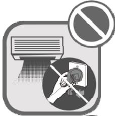
Запрещается включать или выключать кондиционер, непосредственно вставляя и извлекая вилку из розетки.
