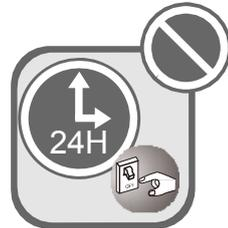
Необходимо подключить устройство к сети за 8 часов до начала работы. Устройство нельзя отключать от сети во время 24-часовой краткосрочной остановки (для защиты компрессора).
