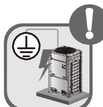
После подключения к сети необходимо убедиться, что устройство правильно и надежно заземлено, чтобы избежать удара электрическим током. Нельзя подключать провод заземления к газопроводу, водопроводу, громоотводу или телефонной линии.
