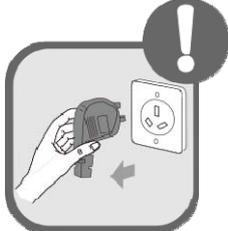
При очистке устройства его необходимо предварительно выключить или отсоединить от сети, иначе возможен удар электрическим током или травма.
